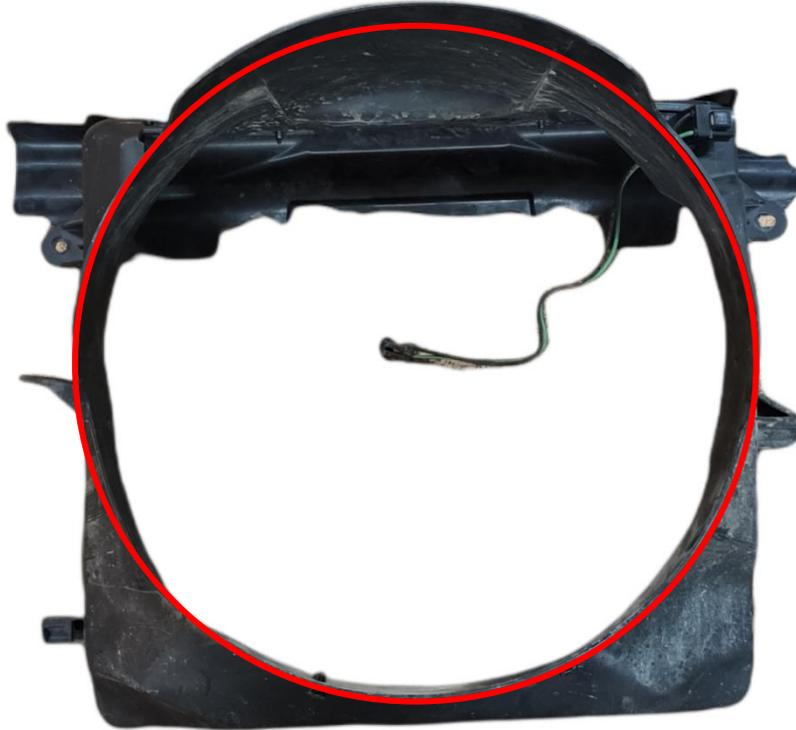
4. Da der ATS Lüfter näher am Wasserkühler sitzt, muss die Stromleitung des E-Lüfters mit Kabelbinder fixiert werden.
