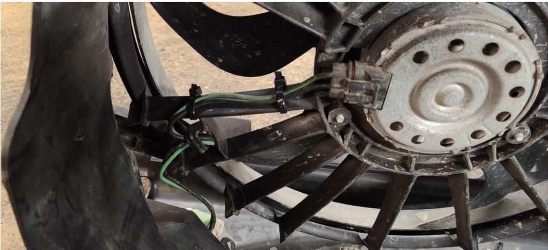
**i** Nach Einbau des ATS Lüfters empfehlen wir das Fahrzeug zu verschränken. Sollte die Lüfterzarge nicht ausreichend angepasst worden sein, wird der Lüfter an der Zarge streifen.
